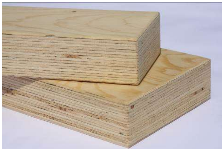
Figuur 8. opbouw van lvl met in de lengterichting gelijkde fineren
