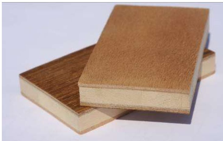
Figuur 5. Meubelplaat bestaat uit een kern van latten of staafjes, bekleed met triplex
