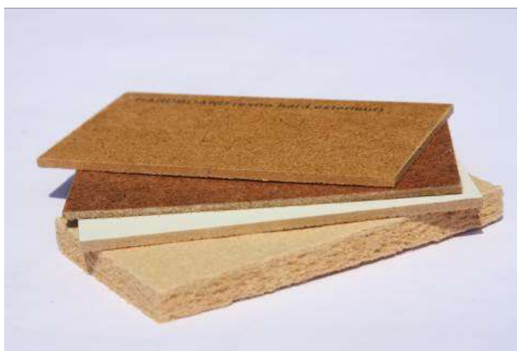
Figuur 12. Drie typen hardboard en zachtboard
