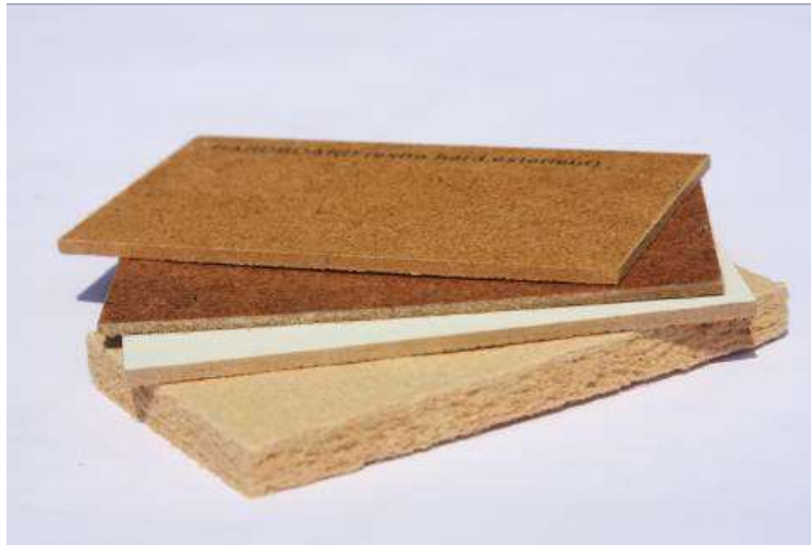
Figuur 12. Drie typen hardboard en zachtboard
