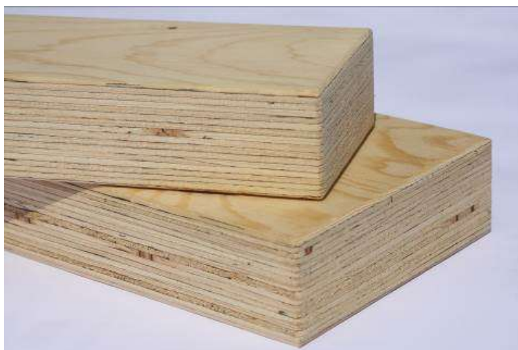
Figuur 8. opbouw van LVL met in de lengterichting gelijmde fineren
