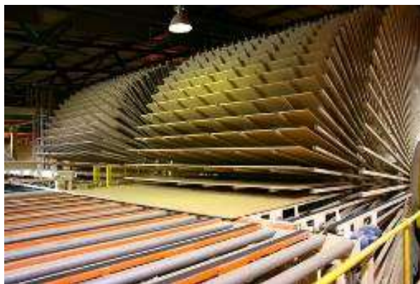
Figuur 13. MDF platen die geperst zijn worden gekoeld. (Foto: Henk ten Bouwhuis, Koninklijke Jongeneel BV).
