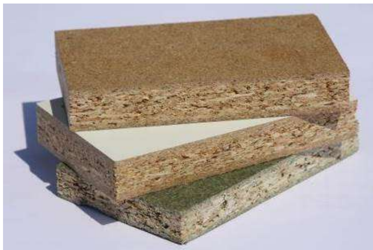
Figuur 16. spaanplaat in verschillende uitvoeringen – standaard, gemelamineerd en vochtwerend (V313)
